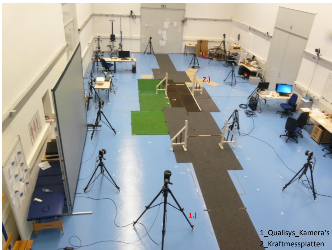
Abbildung 2: Versuchsaufbau des Laufparcours mit Infrarot-Kamera's (1.) und Kraftmessplatten (2.)
