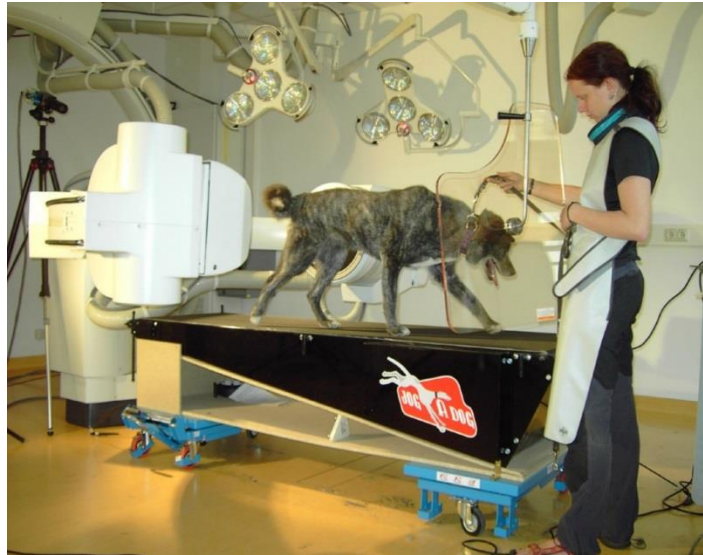
Abbildung 5: Röntgenvideographieanlage (hier uniplanare Aufnahme) mit Laufband
